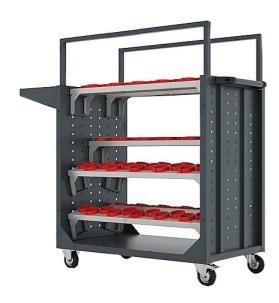
Ширина х Глубина х Высота 1417 x 600 x 1356 (h) м м. Допустимая равно-распределенная нагрузка 7 50 кг.
